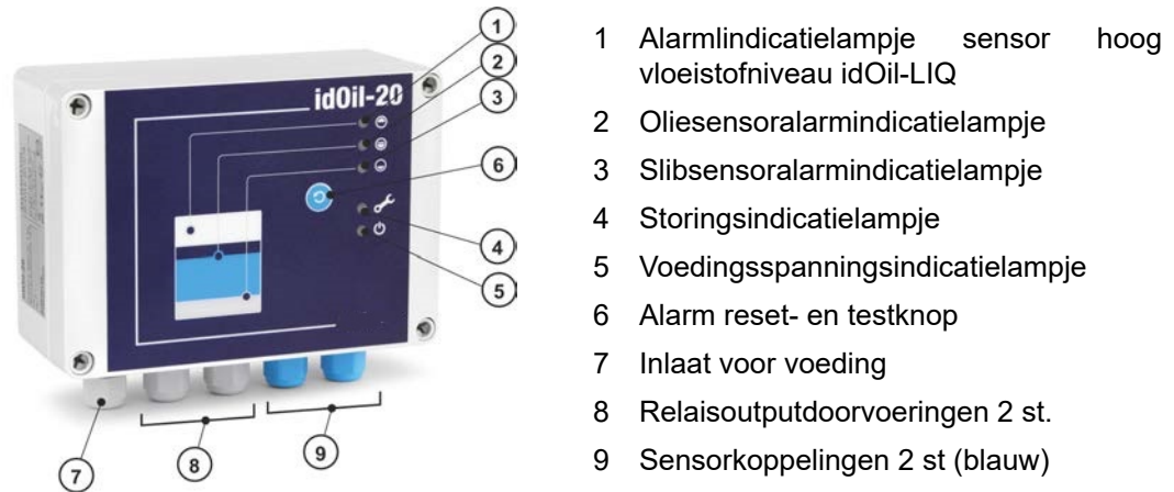
Afbeelding 16. Kenmerken van de idOil-regeleenheid
