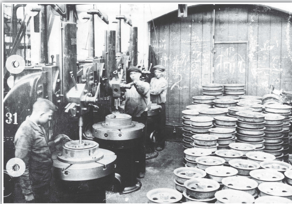
Leerjongens draaien in de wielen voor spoorvoertuigen eindelijk veel gaten met industriële kolomboren. Deze serieproducties kwamen na de grotere investeringen veelvuldig voor.
